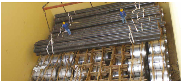
図51: コイル上に積付けされた鋼管は、動きを防ぐためにしっかりとラッシングする必要があります。ダンネージは鋼管と縦隔壁の間に敷設されています。
