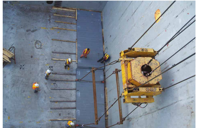
図28: 鋼板は、正方形の船倉に船体を横切って配置されたダンネージ上の前後に収納されています。
