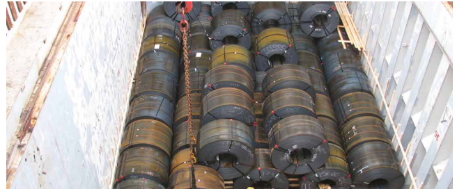
図48:コイルがハッチスクエアにまっすぐに収納。ワイヤ平ひも線が使用されている点に要注目
