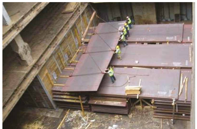
図30: 海上で、条件が許せば、「チョーキングとトミング」を確認します。貨物倉へは会社の貨物積込場所への入庫手順に従って入り、デッキでの作業が可能な海況の場合に限ることに注意してください
