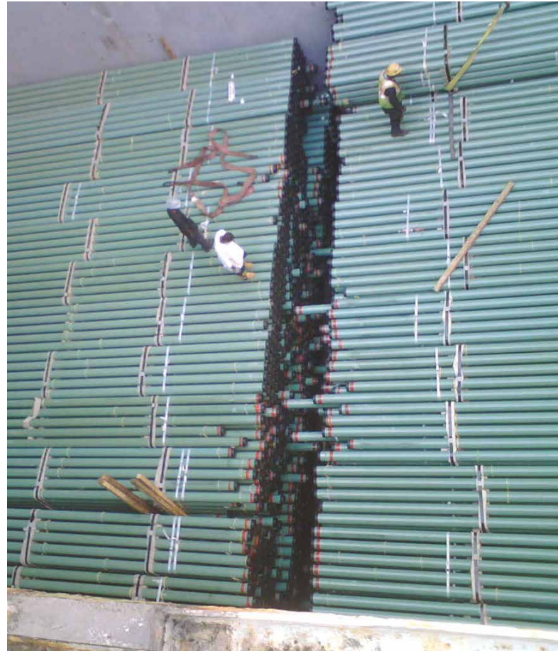
図32: 塗覆装鋼管の束は垂直チョーキングで収納されています
