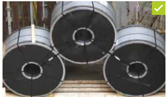
図17: ダンネージ、楔、キーコイルと共に正しく収納されたコイル
