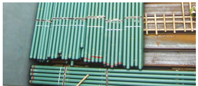
図52: 鋼管は船首から船尾にわたり、また船体を横切って収納されています。ダンネージは、船体を横切って収納された鋼管と船体隔壁の間に敷設されていません。
