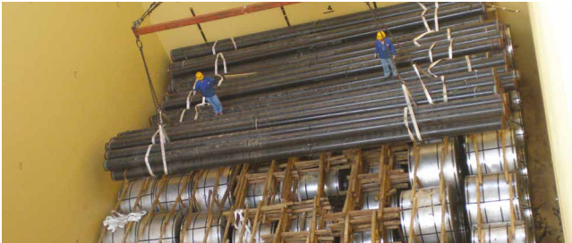
図44:鋼製コイル上に積付けされた銅管
