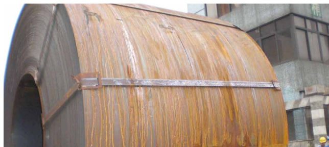
図50: 荷揚げ港でのコイルの状態-発錆
