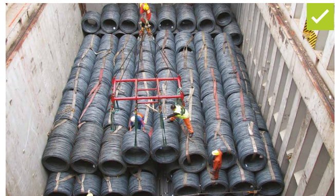
図26:正方形の船倉に正しく収納されたコイル状の線材
