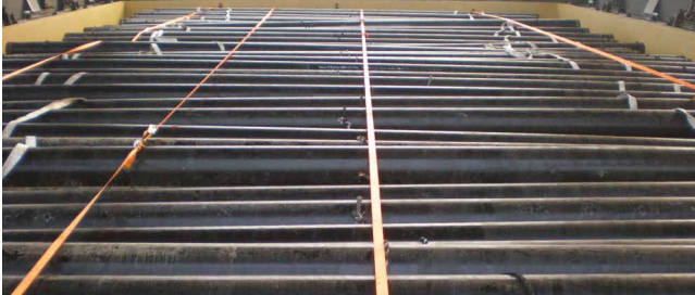
図43:鋼管は船倉に固定されているが、ラッシングはほとんど役に立たない状態
