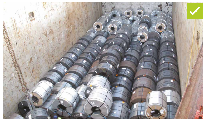
図18: 中心線キーコイルと複数のキーコイルが前後にしっかりと収納されたコイル
