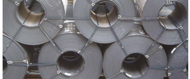
図47:鋼製バンドで収納および固縛されたコイル
