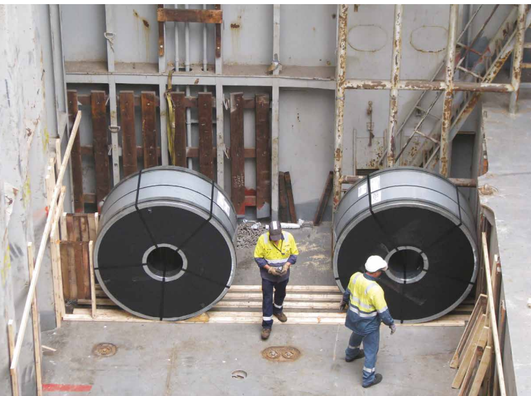
図39: 鋼材の積付け-安全に作業し、個人保護具 (PPE) と高視認性衣服 (High-Visibility Apparel) を着用する
