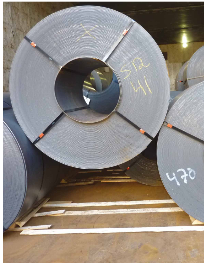
図21: このキーコイルは60パーセント・ルールを超えているように見えます。
