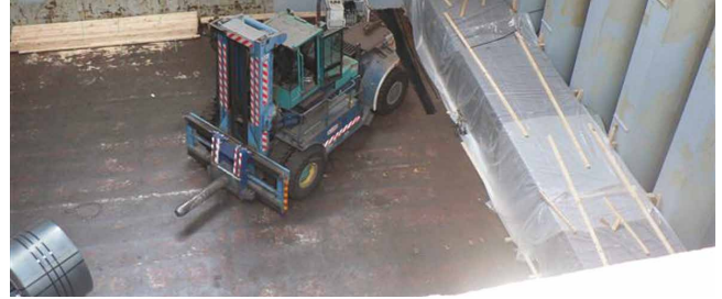
図46:丸いシングルタイヤが取り付けられたフォークリフトによって収納されたコイル
